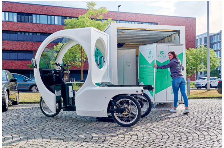
De BOX is losgekoppeld van de Cargobike en wordt in de mobiele HUB gerold
